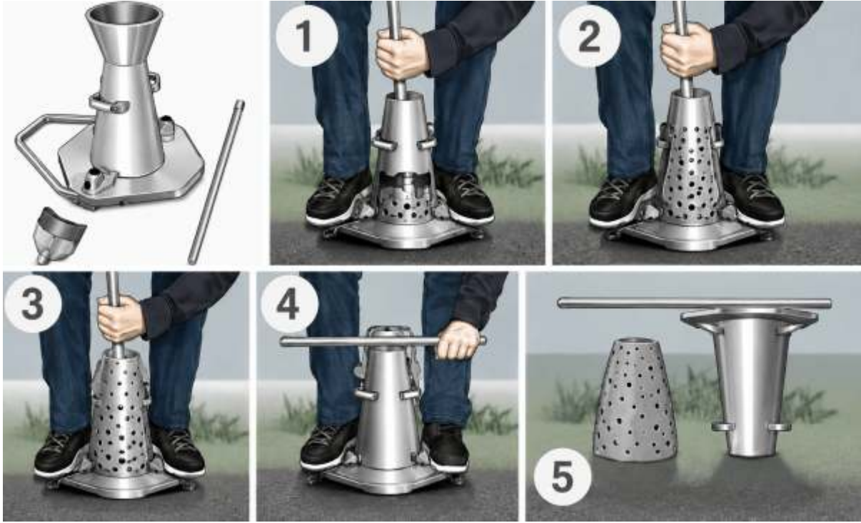
Şekil 6: Slump (Çökme) Deneyi
