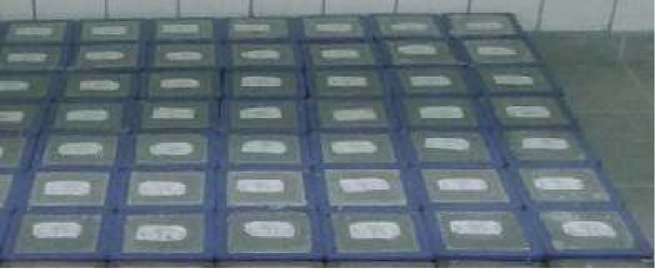
Şekil 8: Beton Numune Kalıpları
